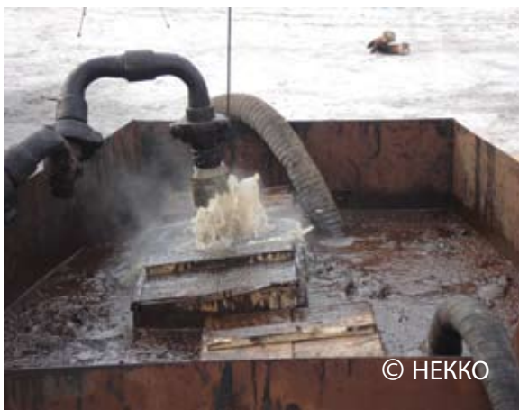
Испытание гидромониторов перфоратора
